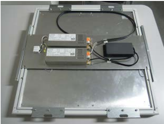
写真ー2 LED照明用電源システムと無線通信モジュール
