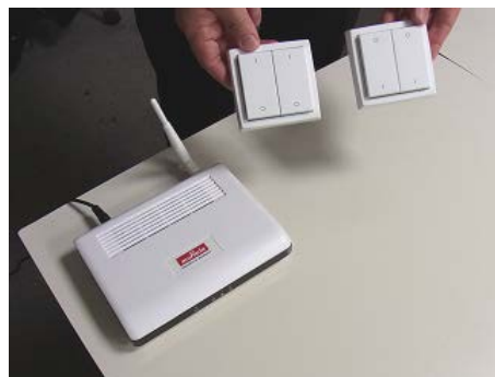
写真-1 照明制御用 Gateway (左) と電池レス無線スイッチ (右)
