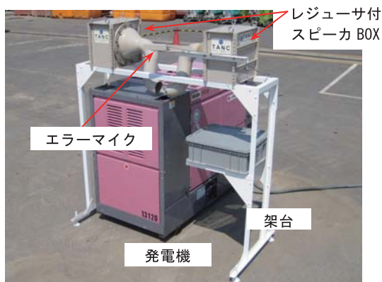
写真-2 ANCシステム設置状況
